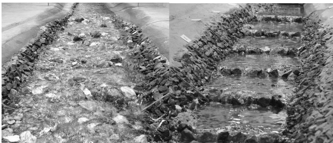
Abb. 4: Physikalische Modellversuche während kleinen Abflüssen. links: mit Blockmischung angereichertes Sohlenmaterial, rechts: künstlich gebaute Blockriegel (Bild: HSR).
