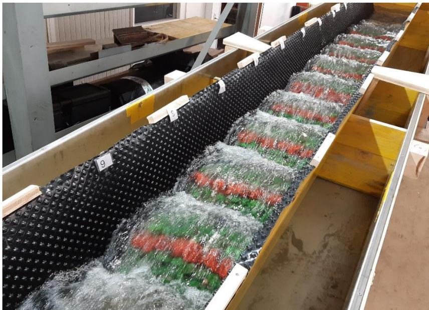
Abb. 2: Idealisiertes Gerinne der Maira im Modell, Fliessrichtung von rechts nach links.
